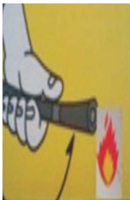
握住皮管，将喷嘴对准火苗根部
